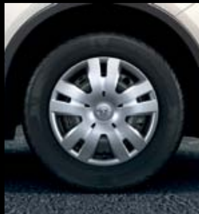
Stalowe obręcze kół 16 x 6,5" opony 205/70 R 16 (RRY). Wyposażenie standardowe wersji Essentia.
