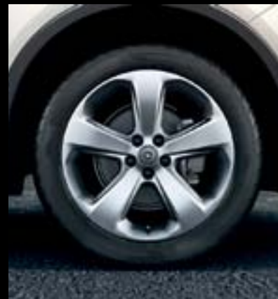
Obręcze ze stopów lekkich 18 x 7" 5-ramienne w kolorze Sterling Silver opony 215/55 R 18 (RV6). Wyposażenie standardowe w wersji Enjoy i Cosmo.
