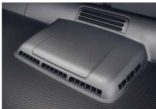
SYSTEM OGRZEWANIA PRZEDZIAŁU PASAŻERSKIEGO. Składa się z wymiennika ciepła i dmuchawy, utrzymując zimą odpowiednią temperaturę z tyłu. Dodatkowa nagrzewnica 2 przyspiesza uzyskanie pożądanej temperatury.
