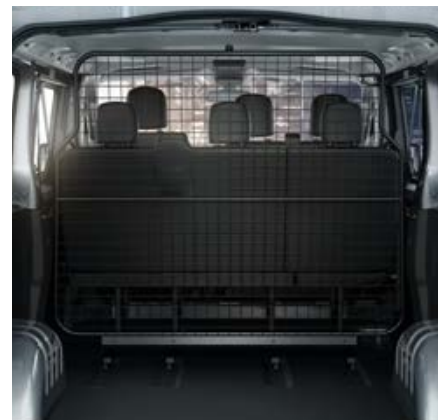
SZTYWNA PRZEGRODA. Oddziela pasażerów od przedziału ładunkowego nie ograniczając prowadzącemu widoczności do tyłu.
