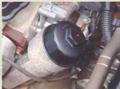
Uklon w stronę ekologów: w Corsie wymienia się nie filtr, ale wkład filtra oleju
