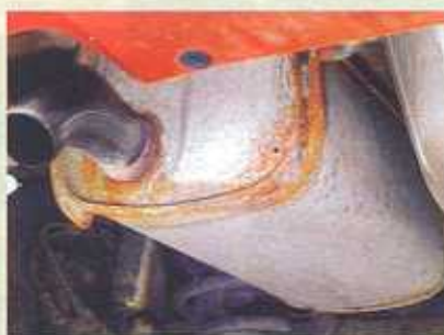
Korozyja wydechu, a szczególnie tylnego tłumika, to typowy problem małych aut
