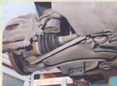
Przeguby napędowe, elementy zawieszenia oraz końcówki drążków są trwałe
