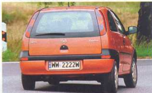
Wrzucenie wstecznego uruchamia wycieraczkę szyby tylnej
