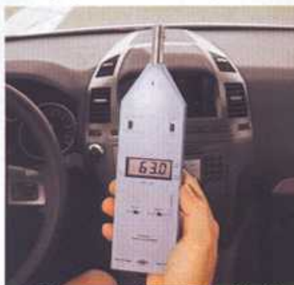
W kabinie przyjemnie cicho. Podczas spokojnej jazdy urządzenie pomiarowe wskazywało tylko 63 dB
