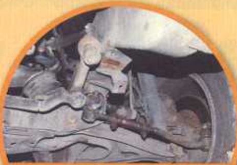
Rdza na podłuznicy to poważniejszy problem, niż się początkowo wydaje. Może świadczyć o powypadkowej przeszłości auta albo o zaawansowanej korozji elementów konstrukcyjnych nadwozia
